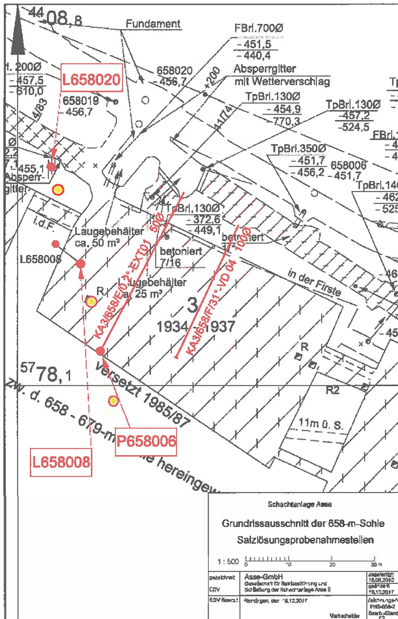
Abbildung 8.3-1: Lage der Probeentnahmestellen auf der 658-m-Sohle
